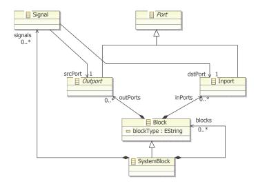
Fig. 2. A fragment of the simplified GASystemModel metamodel
